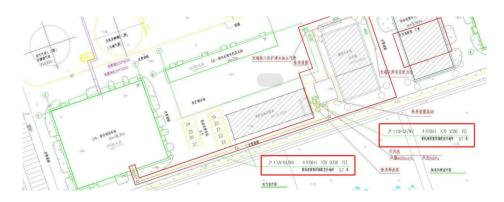
答复: ①总动力电缆和信号线的开挖及回填由采购方负责。②接入一期办公楼一层约 300 米。③电缆型号可增大,不可调小。
